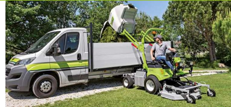
Die Bedienung der hydraulischen Dienste von Grasfangkorb und Mähdeck erfolgt durch mit Sicherheitssperren ausgestatteten Hebeln, die am Armaturenbrett angebracht sind. Das Entladen des Mähguts in die LKW Pritsche ist leicht und schnell wie auch das Anheben des Mähdecks zum Überwinden von Bordsteinkanten.
