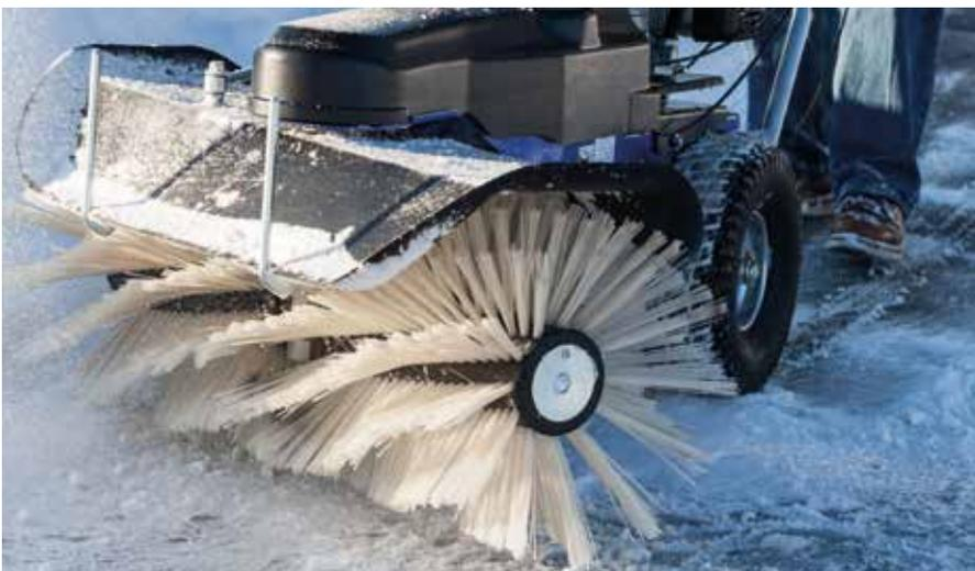
Der Besendruck wird mit einem Drehrad stufenlos an die Arbeitsbedingungen angepasst.
