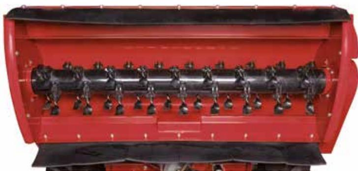
Der handbetriebene Schlegelmäher FM 35 wurde für die Bearbeitung von anspruchsvollem Gelände entwickelt und ist ideal zum Mähen von rauen und überwucherten Flächen.
