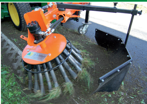
Wurfschutz verhindert das Wegschleudern von Schmutz
