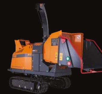
**Hochgeschwindigkeitsraupen** - Doppelte Hydraulikpumpe für hohe Raupengeschwindigkeit und ein hervorragendes Drehmoment.
