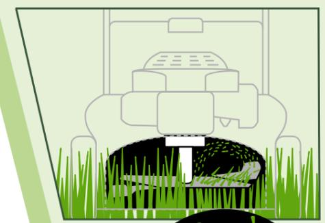
Alle Honda-Rasenmäher mit Versamow™ sind mit einem Microcut-Zwillingsmessersystem ausgestattet, welches das Schnittgut in winzige Partikel verkleinert. Das gehäckselte Schnittgut fällt als Mulch zurück auf die Grasnarbe.
