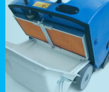
Leichter Zugang zum Entleeren des Kehrgutbehälters des ECO 520 B.
