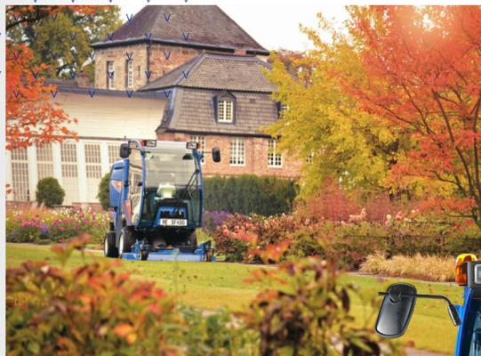
Die Vollglaskabine ermöglicht direkte Sicht auf Mähwerk und Rasenfläche.
