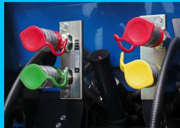
4 farblich gekennzeichnete Hydraulikanschlüsse der 2 serienmäßigen Steuerkreise
