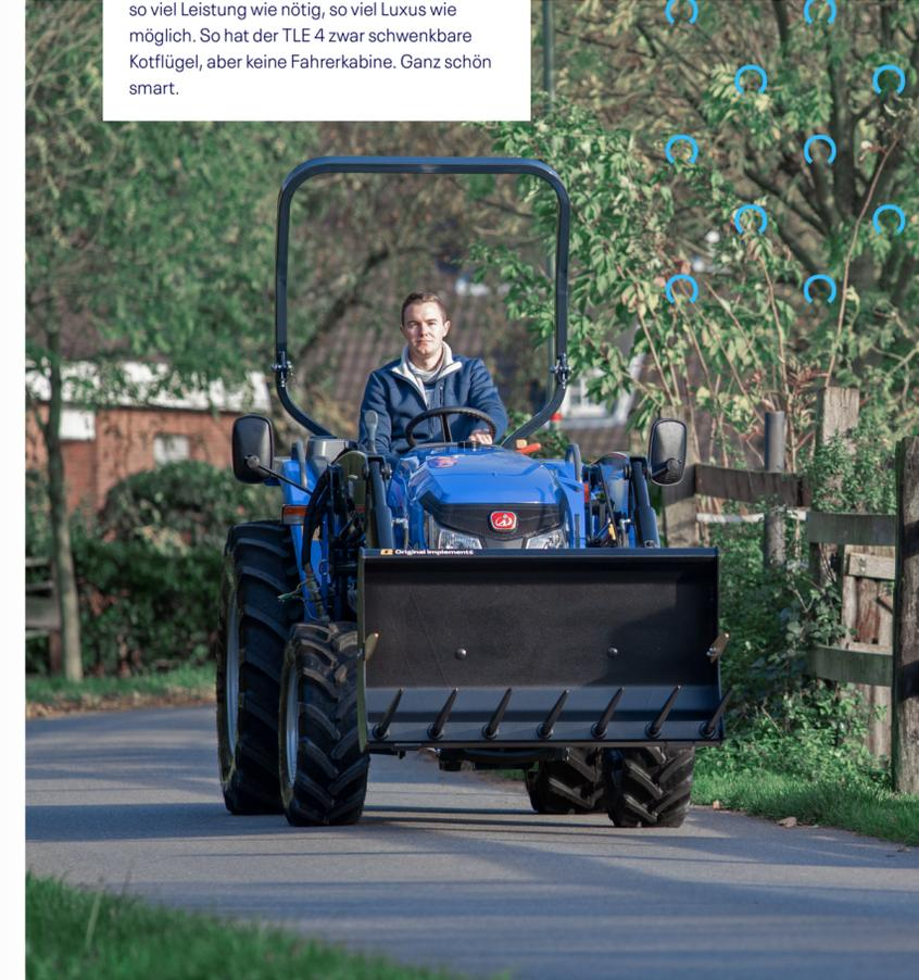
Kraftvoll von vorne bis hinten: vorn mit starkem ALÖ-Frontlader, hinten mit 1.200 kg Hubkraft am Heck.
