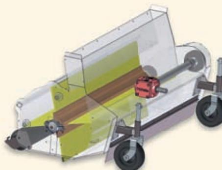
**Testa spazzolatrice** di facile sostituzione con la testa trinciatrice.
