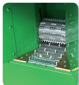
Nuovo sistema di trascinamento potatura tramite catena dentata idraulica.
