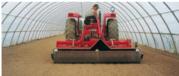
Interramento sassi e detriti e semina in un unico passaggio. One-pass stone and debris burying and sowing. Enfouissement des cailloux et des débris et semences en un seul coup. Eingraben von Steinen und Rückständen und Säen in einem Arbeitsgang.
