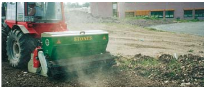
Interramento sassi e detriti e semina in un unico passaggio. One-pass stone and debris burying and sowing. Enfouissement des cailloux et des débris et semences en un seul coup. Eingraben von Steinen und Rückständen und Säen in einem Arbeitsgang.
