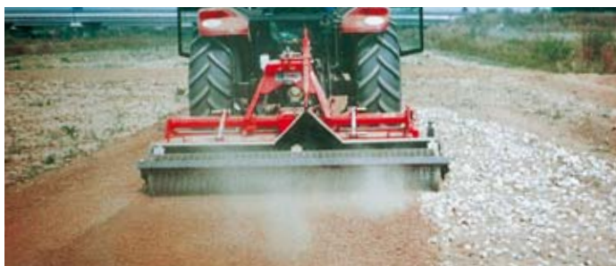
Interramento pietre per preparazione letto di semina. Stone burying for seed-bed preparation. Enfouissement des pierres pour la préparation du lit de semences. Eingraben von Steinen zur Vorbereitung des Saatbettes.
