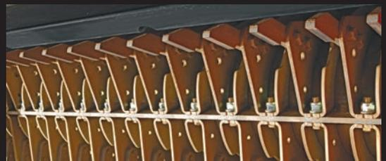
Die haltbaren Karbidmesserspitzen des Zerkleiners ergeben in vielen Bodentypen eine ausgezeichnete Leistung.
