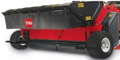
Die Räder geben zusätzlichen Halt auf weichem Boden oder Boden mit flachen Wurzeln.
