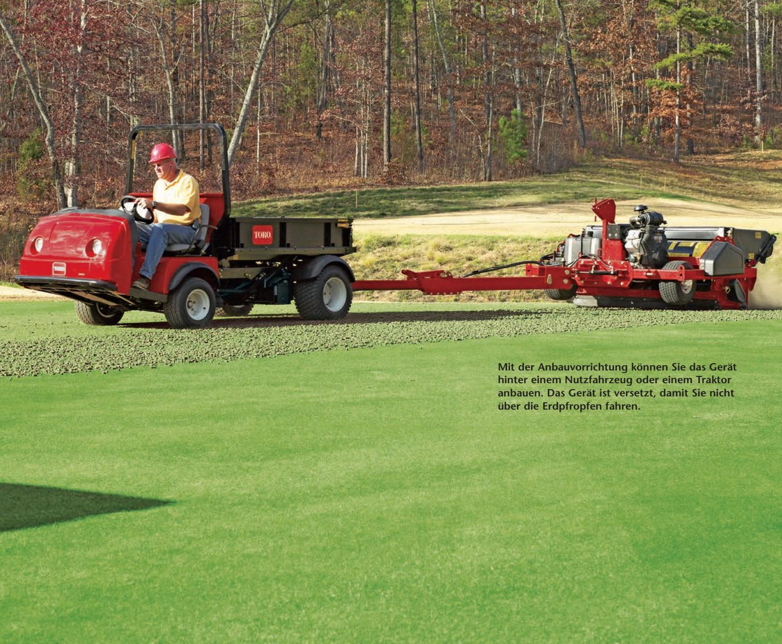
Mit der Anbauvorrichtung können Sie das Gerät hinter einem Nutzfahrzeug oder einem Traktor anbauen. Das Gerät ist versetzt, damit Sie nicht über die Erdpfropfen fahren.
