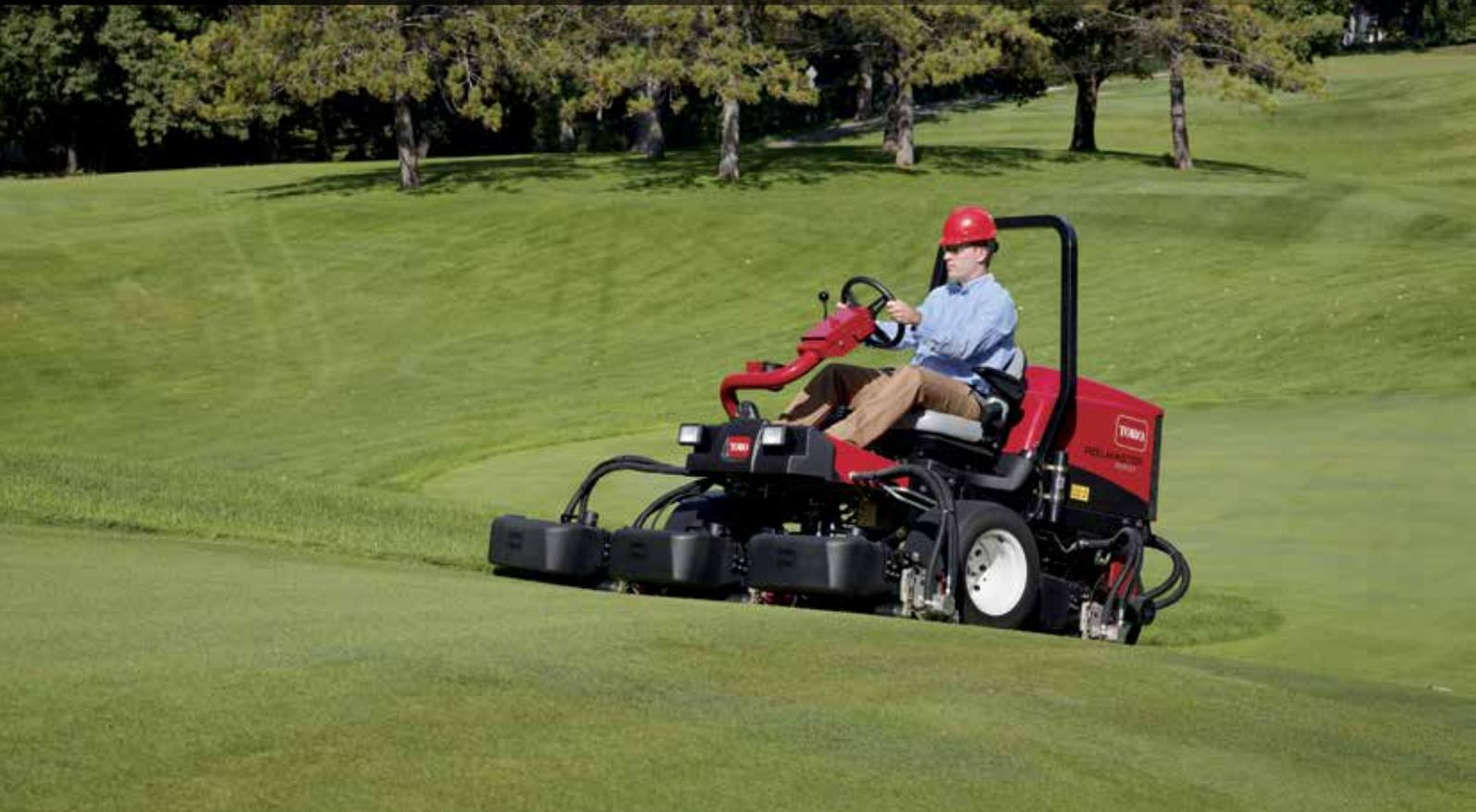
Der Reelmaster 3550-D hat einen Kubota-Dieselmotor mit 18,5 kW (24,8 PS) und genug Kraft zum Befahren von Hanglagen selbst bei aktivierten Groomern und Heckrollenbürsten. Dank der standardmäßigen Ausstattung mit Serien/Parallel-Dreiradantrieb, ist der Reelmaster 3550-D in der Lage, auch seitliche Hügel und Grünstreifen zu mähen, ohne den Rasen zu beschädigen.
