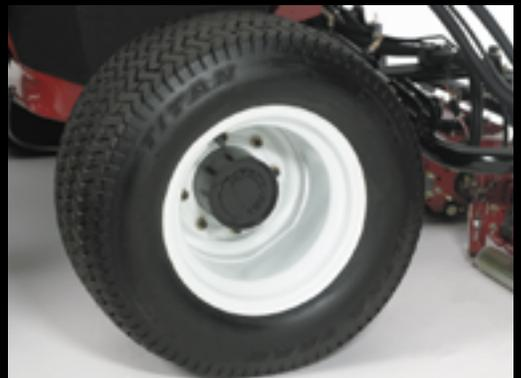
Das Radantriebssystem mit Planetengetriebe ergibt eine bessere Leistung der Traktionsystemhydraulik und eine geringere Wärmerwicklung. Dreifache Nassescheibenbremsen ergeben mit dem Planetengetriebe eine sichere Fahrt zwischen den Fairways.
