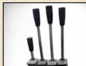
Vier im Fahrerhaus gelegene Zugkabel-Bedienhebel (oder elektrohydraulische Steuerungen).
