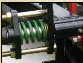
Tragwerkfederung zur Senkung der Kollisionsschäden.
