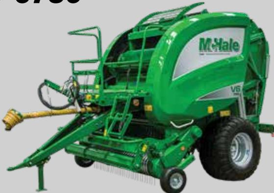
Die McHale V 6750 ist eine automatische variable Rundbalenpresse mit bis zu 25 Messer im Schneidwerk und Hochleistungsrotor. Sie ist außerdem mit einem Doppelantrieb versehen, mit der die Maschine auch unter schwierigsten Bedingungen zuverlässig arbeitet. Der Doppelantrieb unterstützt Riemendrehung und Materialformung.
