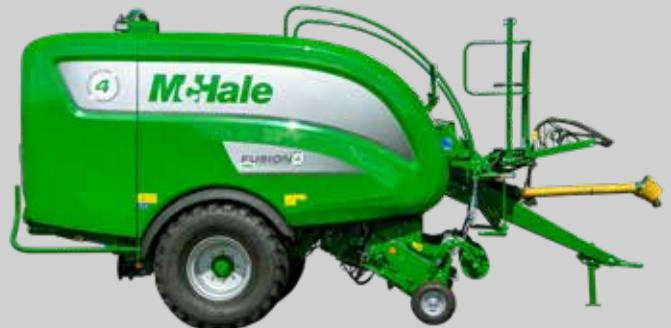
Die McHale Fusion 4 PLUS ist eine vollautomatische, integrierte Press-Wickelkombination, die Folie oder Netz auf die Mantelfläche des Ballens aufträgt, damit eine optimale Ballenform und -dichte liefert. Die Fusion 4 Plus kann hochwertige Futterqualität liefern, durch Verwendung der Folienbindung, mit der eine bessere Silage Qualität und leichtere Verfütterung erreicht wird.
