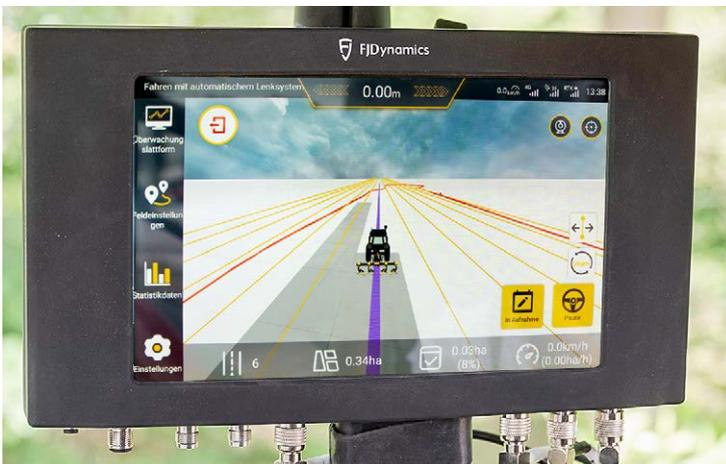
Das ist die Fahransicht des Premo+, unten rechts sind die Aktivierungsbuttons zum Lenken und zur Aufzeichnung der bearbeiteten Fläche.
