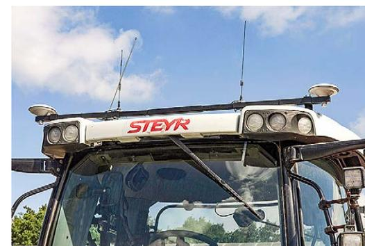
Außen sind die GNSS-Antennen, in der Mitte Radio, Mobilfunk und WLAN angeordnet.
